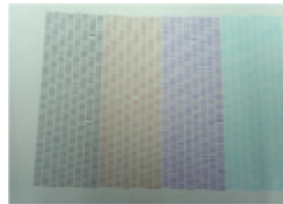
test print con inyectores obstruidos o desviados
