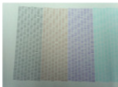
test print con inyectores obstruidos o desviados
